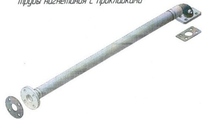
Изометрическое изображение трубы нагнетания с прокладками
